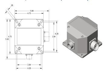
Nema 4X, Conduit Hubs (B6 enclosure)
